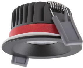
Especificaciones Ledvance Foco LED Fire Rated Aluminium Negro 8W 640lm 36D - 927 Luz muy Cálida | Recorte 68mm - IP65 - Mejor reproducción de color - Regulable
